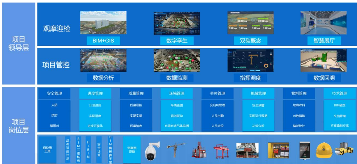
智慧工地系统架构图
