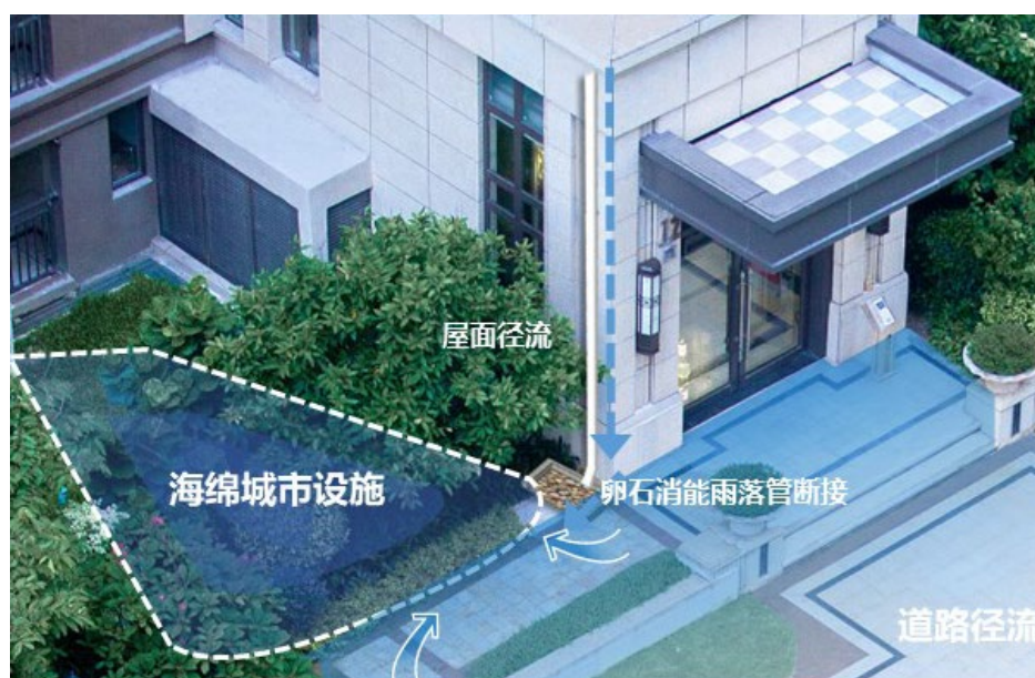
图6.3-6屋面排水与海绵城市设施衔接示意图
