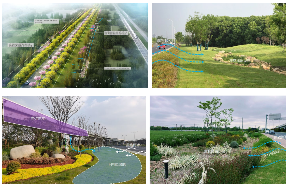
图 6.4-10 典型海绵城市设施径流组织示意图
