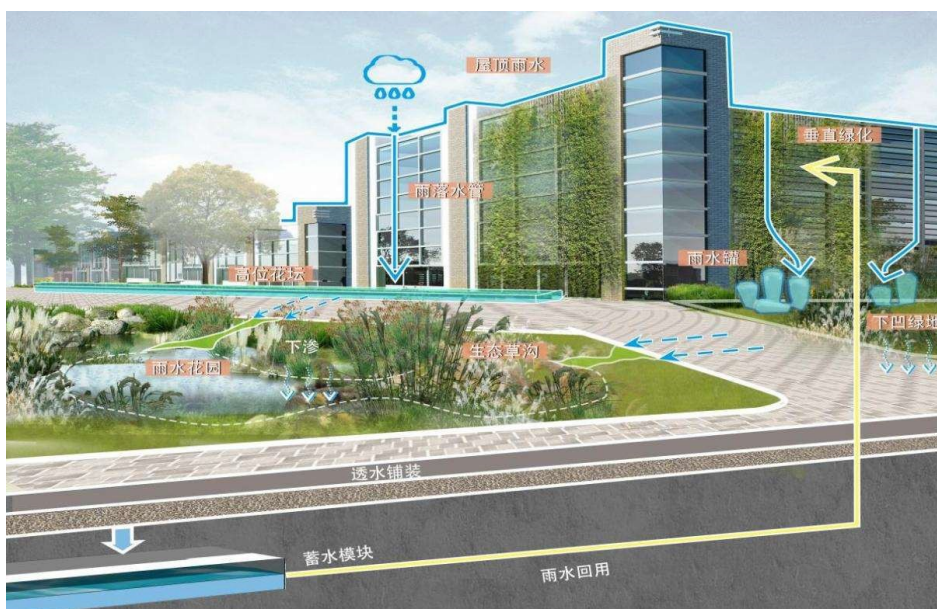
图6.3-6道路排水与雨水回用示意图
