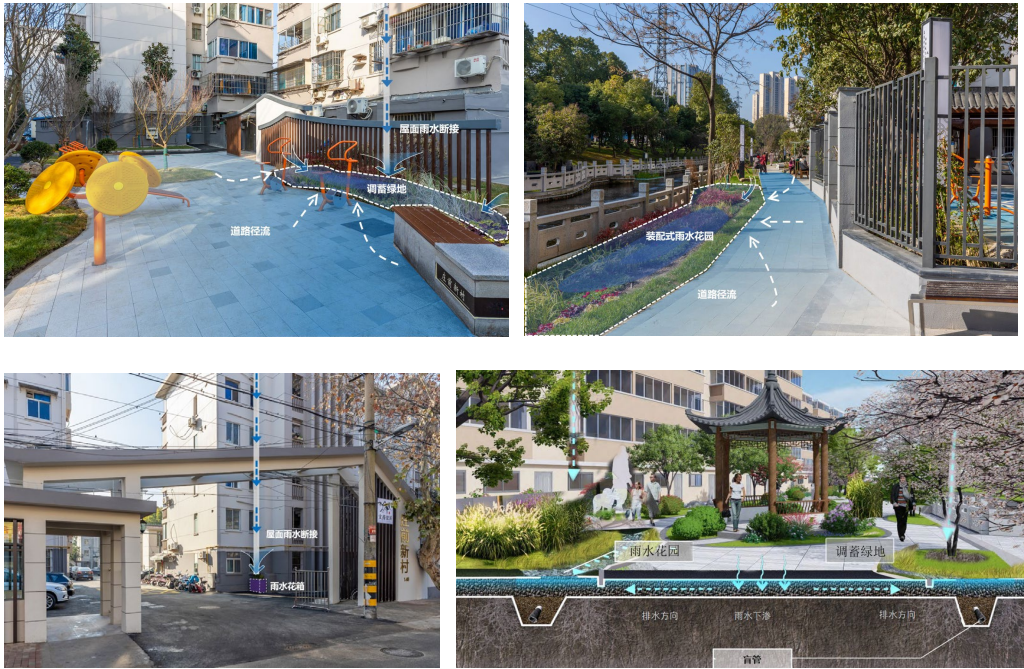
图6.3-17典型海绵城市设施径流组织示意图
