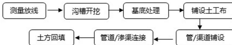
图5.6-1 渗管/渠施工工序图
