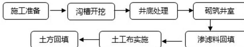
图5.6-2 渗井施工工序图
