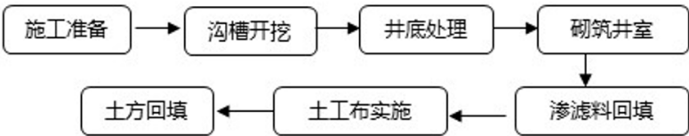
图5.6-2 渗井施工工序图
