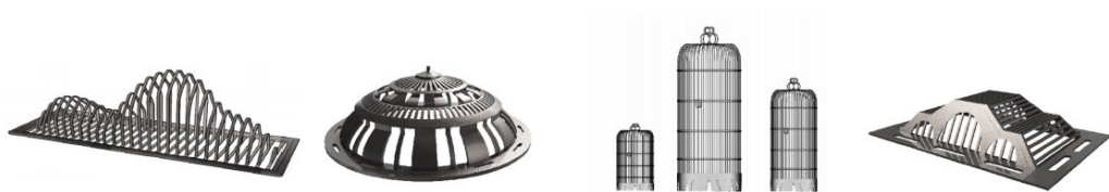
图 5.2-26 溢流口篦子做法示意
